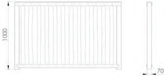
Garde-corps de sécurité en acier et bambou constitué de montants tube carré 70x70mm ; main courante en tôle pliée largeur : 80mm, remplissage en bambou Ø60/70mm.
