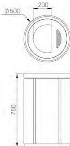
Corbeille cylindrique ajourée en tôle acier, couvercle avec cendrier intégré et porte sac pivotant, visibilité du contenu répondant aux normes de la loi Vigipirate, contenance 100 Litres.
