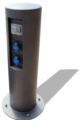
Borne de distribution électrique en acier de diamètre Ø273 mm sur platine. Emplacement comportant 2 prises électriques et disjoncteurs différentiels 30mA par prise avec volet étanche de protection.
