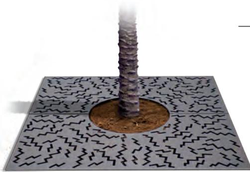
Grille d'arbre en acier avec motifs « zig-zag » découpés en plusieurs parties assemblées par boulonnage. Conforme à la norme P98-350 d'accessibilité PMR.
