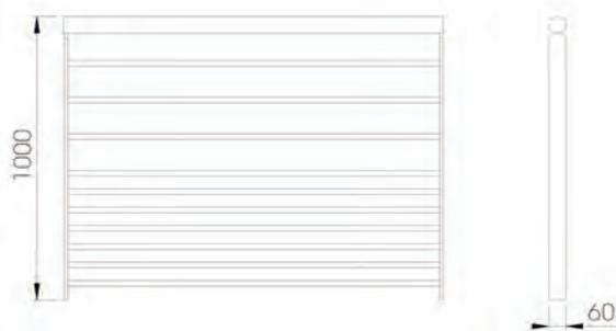
Garde-corps de sécurité en inox 304L constitué de montants en fer plat 60x12mm, main courante en tube Ø60 mm; barreudage horizontal en tube Ø21mm.
