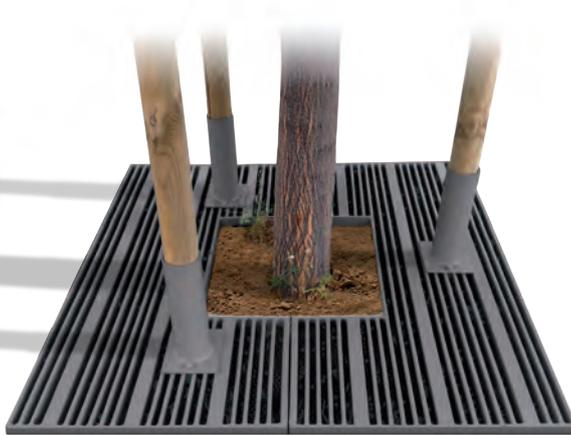
Grille d'arbre en acier composée de 2 parties en plat sur champ d'épaisseur : 10mm et tubes 35x35mm. Fond en tôle perforée. Conforme à la norme P98-350 d'accessibilité PMR.
