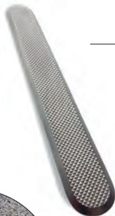
Barre podotactile de guidage au sol en inox brossé 304L à sceller avec surface antidérapante gaufrée, utilisée pour avertir les personnes malvoyantes d'un danger imminent. Contraste visuel par rapport au sol à respecter. Conforme à la norme française NF P 98-351.
