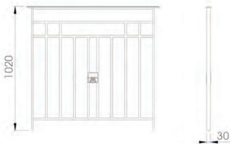
Garde-corps de sécurité en acier constitué de montants en fer plat 30x12mm, main courante moulurée 40x10mm, remplissage en barreaudage vertical en carré de 16mm.
