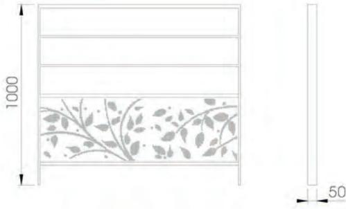
Garde-corps de sécurité en acier constitué de montants en fer plat 50x10 et main courante en fer plat 50x20mm, barreaudage horizontal en fer plat 50x10mm, remplissage par tôle avec motifs micro-perforés, montant de jonction épaisseur : 15mm entre chaque modules.
